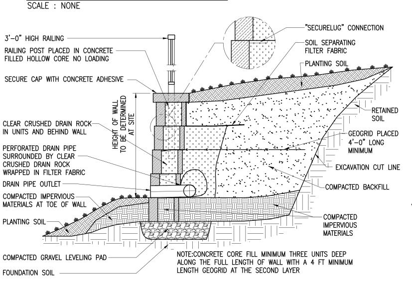
MASONRY RETAINING WALL SYSTEM DETAIL
